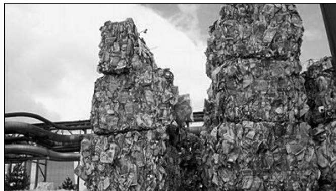
Pro recyklaci nápojových kartonů je podstatná papírová část. Zbylý polyetylen a hliník se využije např. jako palivo do cementáren.
