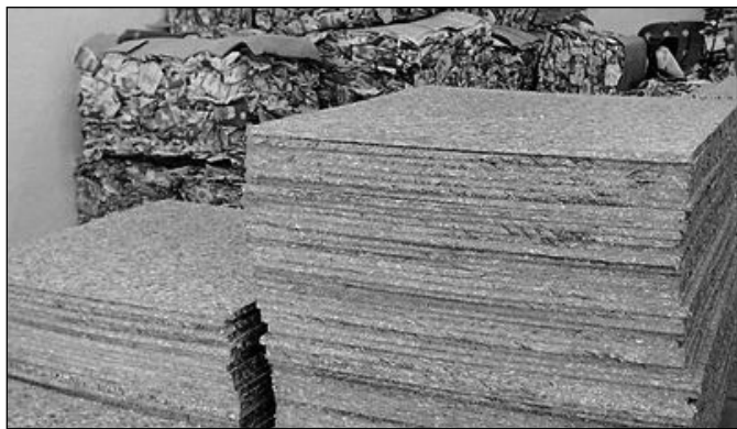
Druhou možností recyklace nápojových kartonů je výroba stavebních desek.
