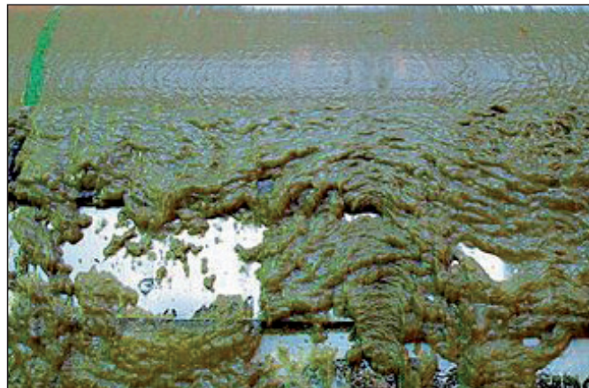
V papírnách se sběrový papír tzv. rozvlákňuje – vsype se do nádrže s vodou, kde se rozmixuje. Čistá směs je základem pro výrobu papíru.
